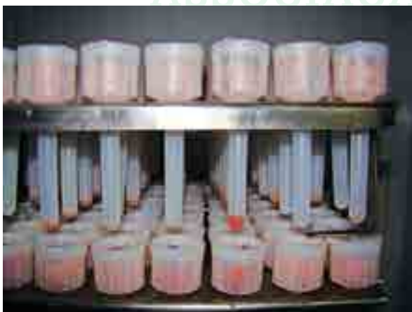
Foto 7 – Método de exsudação por gravidade para medir a perda por gotejamento da carne suína (EZ DripLoss)
