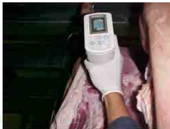
Foto 5 – Análise de cor pelo uso do colorímetro Minolta
