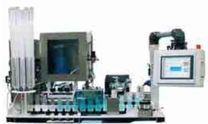
Foto 7 – Sistema automático de fracionamento e envase de sêmen FONTE: ACERVO DOS AUTORES
