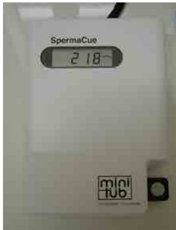
Foto 4 – Fotocolorímetro utilizado para determinação da concentração espermática
