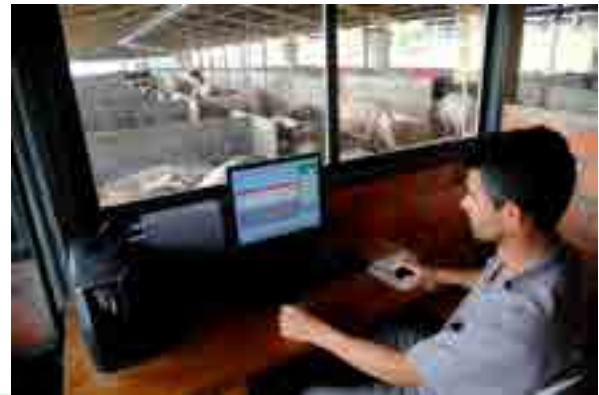
Foto 4 – Sala de controle com software para gerenciamento do sistema de alimentação eletrônica individualizada das matrizes
