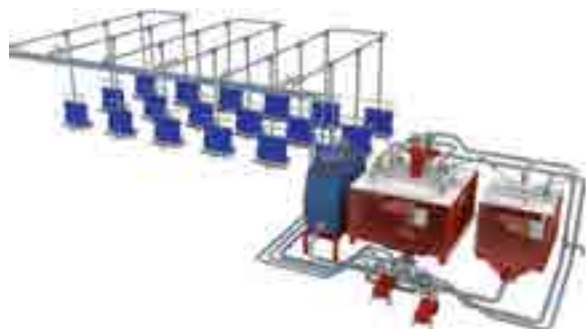
Figura 1 – Esquema de sistema de arraçamento de dieta líquida
